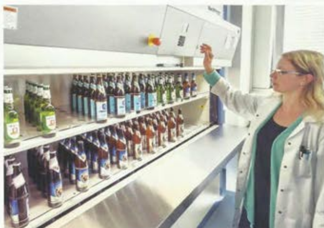
Auf Anforderung wird der Multifunktions-Tragsatz schnell zur Entnahmestelle transportiert
